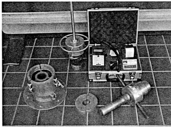
Bild 2. Versuchsgeräte für den Dynamischen CBR-Versuch.
